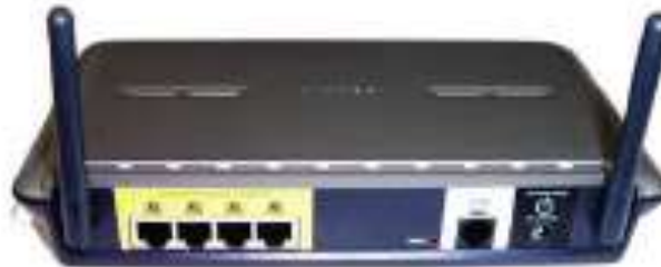
Primer uređaja koji predstavlja pristupnu tačku, svič i ruter
